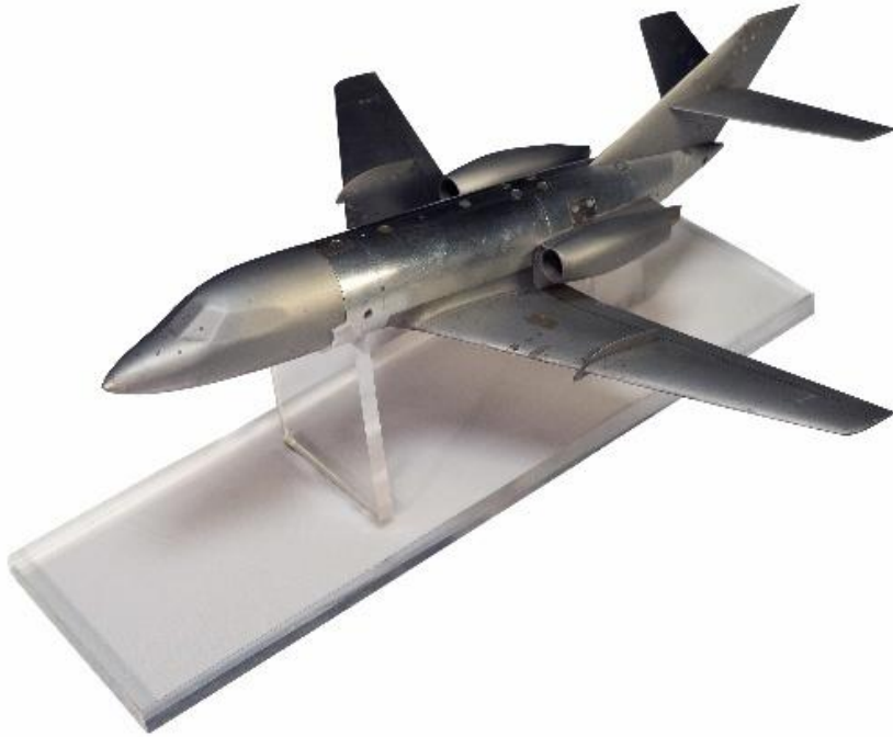
Mystère 20 , début des années 1960 Maquette de soufflerie S 1004 FEV, échelle 1/35 Métal, 18 x 73 x 47 cm Saint-Cloud, Dassault Aviation
